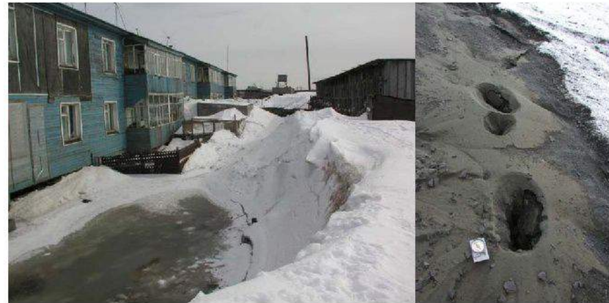
Камчатка: разжижение грунта при Олюторском земл. 21 апр 2006, M_w \sim 7.8 (фото Т. Константиновой)
