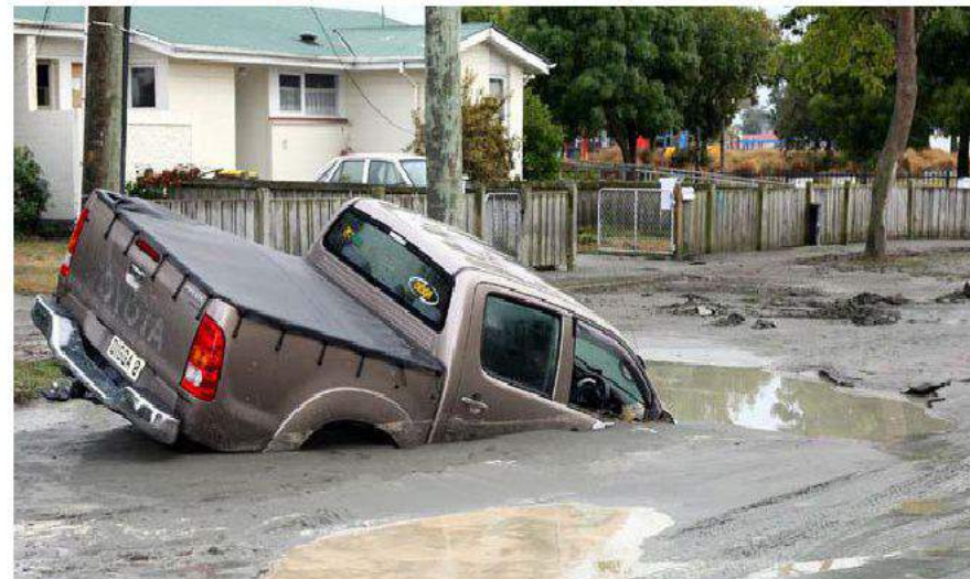
Крайсчерч, Новая Зеландия: разжижение грунта при земл. Февр 2011, M_w \sim 6.3
